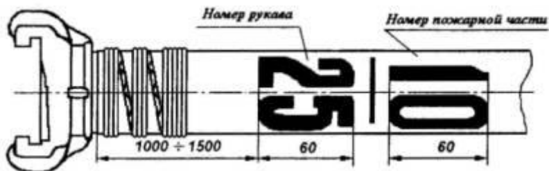
Рис. 3. Дополнительная маркировка рукава в пожарной части
